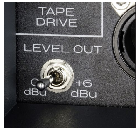
Studio- oder HiFi-Level? Die Ausgangsspannung lässt sich um sechs Dezibel heraufsetzen.
