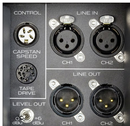
Die neue Revox besitzt ausschließlich dreipolige XLR-Anschlüsse plus einen Satz Cinch-Adapter.
