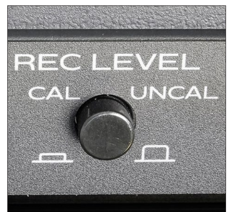
Per Knopfdruck: kalibrierter Pegel übers Mischpult (Cal) oder Aufnahmeaussteuerung am Gerät.
