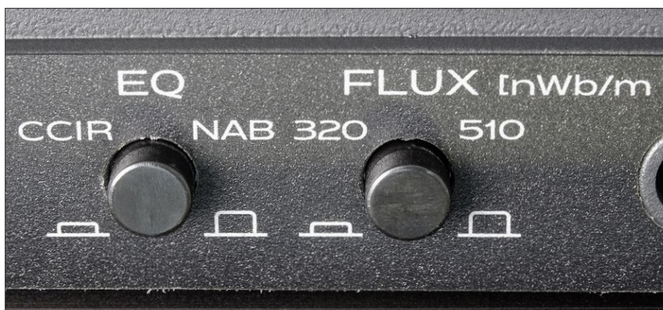
Daran erkennt man den professionellen Ansatz der MK III: Die Entzerrung ist zwischen CCIR und NAB umschaltbar; ebenso die magnetische Flussdichte von 320 Nanoweber pro Meter auf 510 nWb/m.
