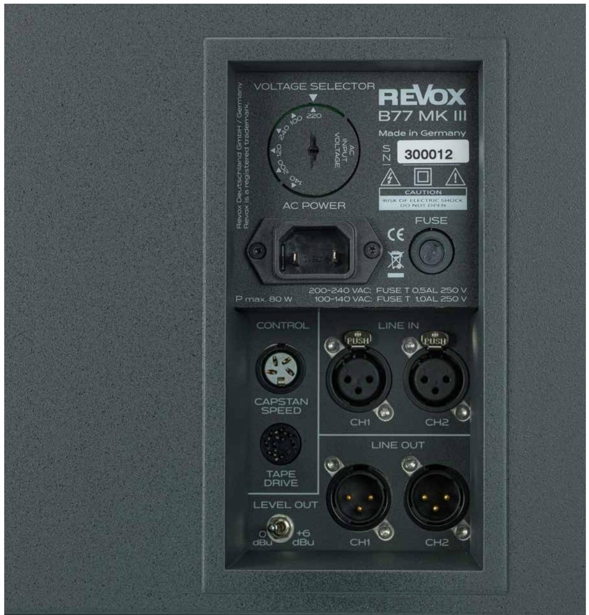
Im Gegensatz zu den Originalversionen ist die MK III konsequent symmetrisch aufgebaut, wie an den XLR-Ein- und Ausgängen zu erkennen. Vom Spannungswahlschalter lässt der Laie vorzugsweise die Finger.
