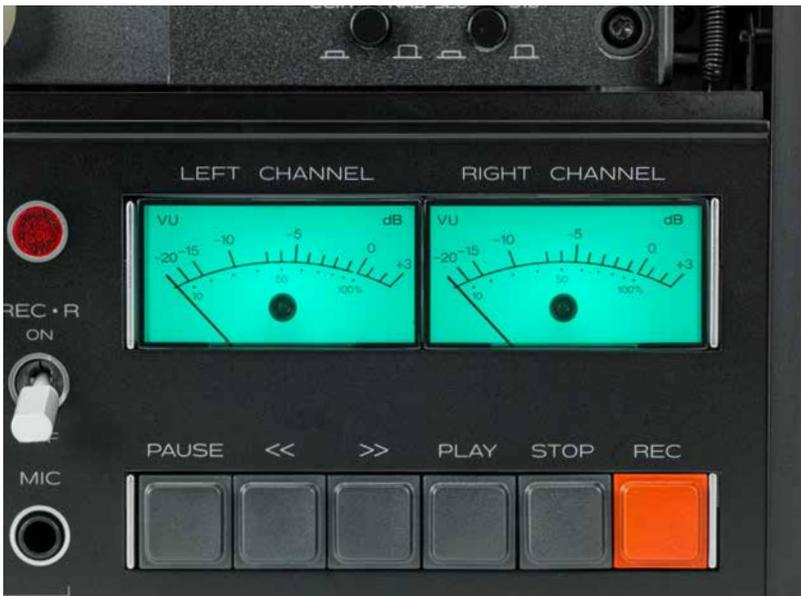
Während die VU-Meter an modernen Endstufen im Grunde als Schmuckwerk gelten dürfen, erfüllen sie bei einer Bandmaschine eine echte Funktion.
