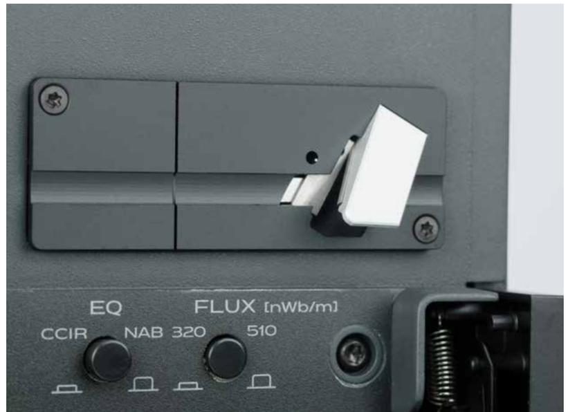
Involviertes Hörvergnügen: Ein Crashkurs in Bandkunde ist für die sachgerechte Bedienung klar zu empfehlen. Die Druckknöpfe im oberen Bild etwa erlauben eine Umschaltung zwischen je zwei Entzerrungskurven und magnetischen Flussdichten, um die Abspielbedingungen an verschiedene Bandtypen anzupassen.
